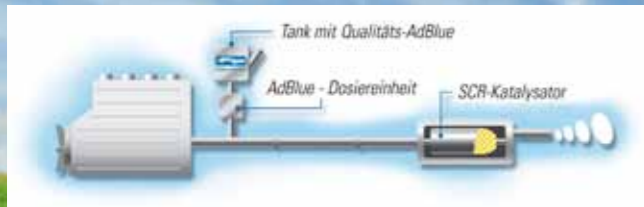
Abb. AdBlue® wird vor einem Stickoxid-Katalysator in den Abgasstrom geregelt eingespritzt.
